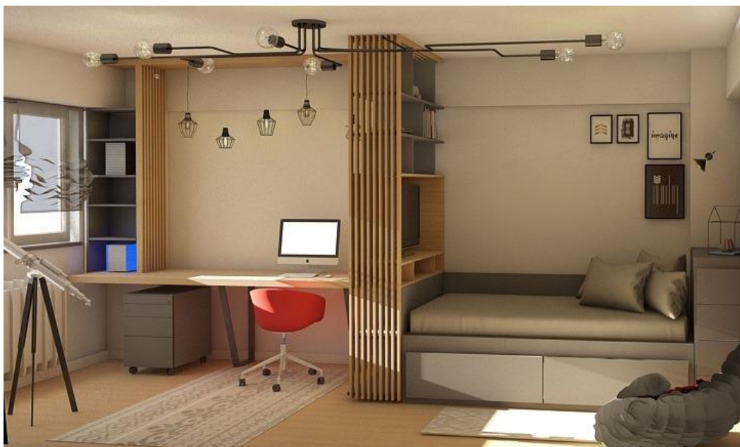
CORP DE ILUMINAT REALIZAT DIN TEAVA METALICA CURBATA VOPSITA NEGRU IN CAMP ELECTROSTATIC CU 8 BECURI, LEGATE LA O SINGURA SURSA DE LUMINA
